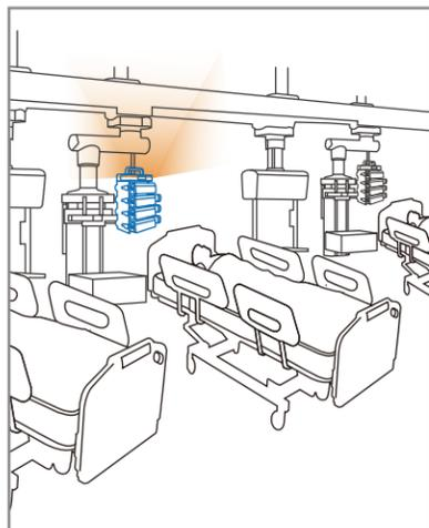
Localisation rapide de l'alarme de chevet grâce à une alarme visible à 270° de BeneFusion nDS à distance.
